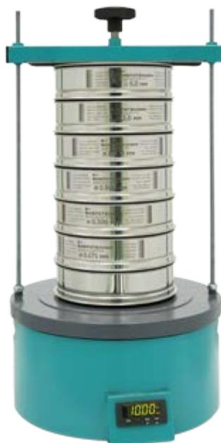
Рис. 2 Анализатор ситовой А 20
