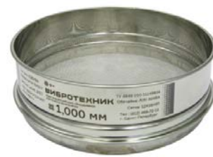
Рис. 3 Сито лабораторное С20/50
