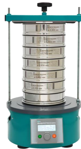
Рис 2. Анализатор А 20 на базе вибропривода ВПС
